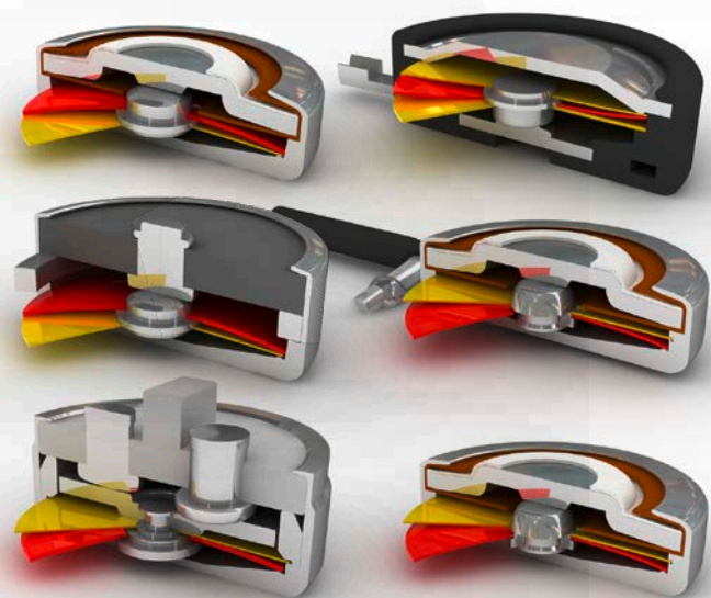
Fig. 3: protettore termico in apertura con reinserzione automatica e sensibile alla temperatura con disco con scatto a molla supplementare (andamento non lineare)
